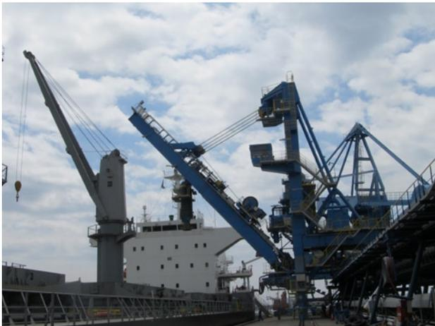
写真4 クリンカー積込設備
