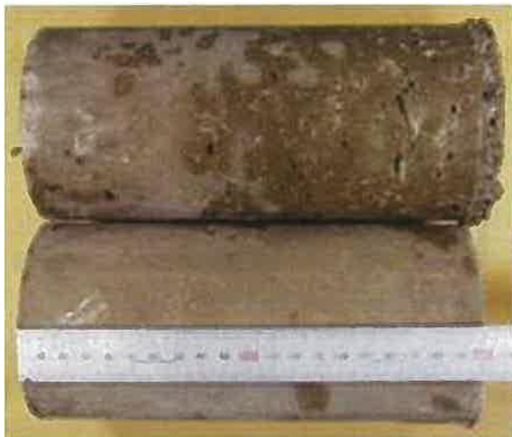
上：熔融スラグにより膨張した供試体 下：膨張抑制剤を添加した供試体
