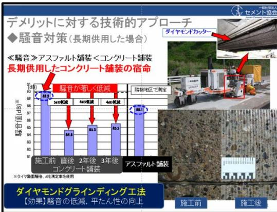
東京都北区道のコンクリート舗装に低騒音化技術ダイヤモンドグラインディング工法を適用した例。
