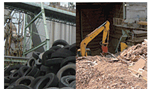
セメント工場では、廃タイヤや廃木材などの廃棄物を有効に生産工程に組み入れ、原料や熱エネルギーの一部として活用しています。
