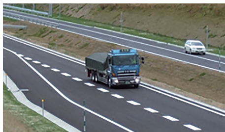
走行抵抗試験を成田空港内誘導路(2006年)、国総研試走路・道東自動車道(2007年)にて実施。走行抵抗がアスファルト舗装よりも6~20%程度小さいという結果が得られています。
