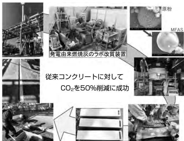
図13 MFASジオポリマーコンクリートの製造システムイメージ
