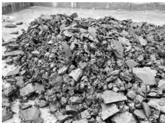
写真6 フィルタープレスで固液分離した固形分
