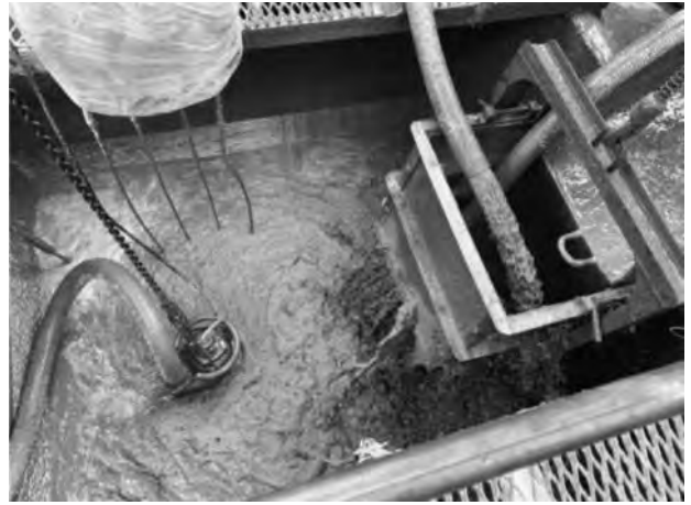
写真3 プレキャストコンクリート製品工場で発生するコンクリートスラッジ
