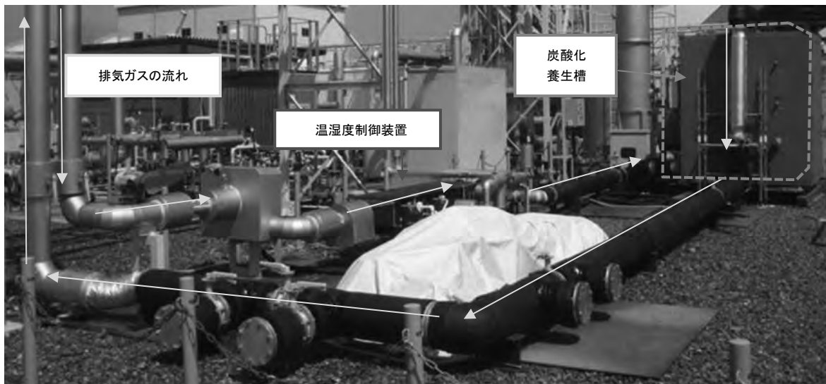
写真3 ゼロエミッションタイプの炭酸化養生設備の概要
