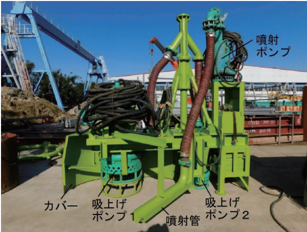
写真1 スクレーパー型スライム処理機
