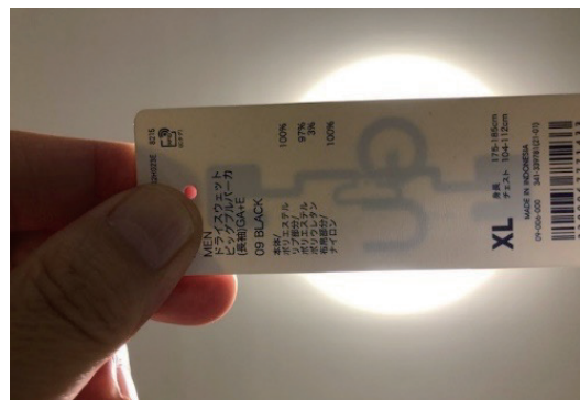
写真1 衣料品のタグに内蔵されているICタグ
