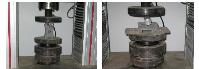
写真4 iコンスパーサの破壊強度試験
