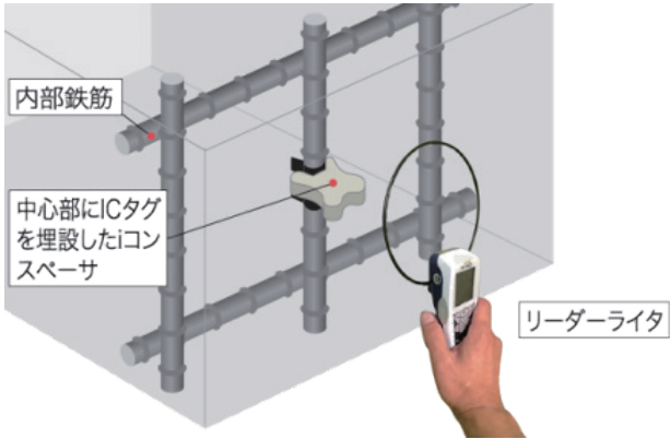
図3 iコンスペーサを活用したかぶり厚検査
