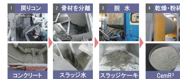
図2 CemR 3 の製造工程
