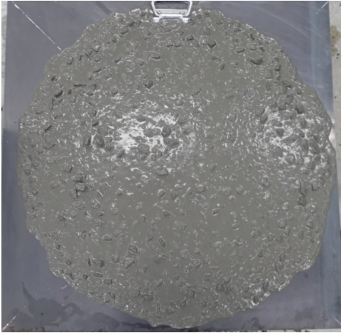
写真1 目標練上がり温度33℃のスランプフロー（W/C=14%）
