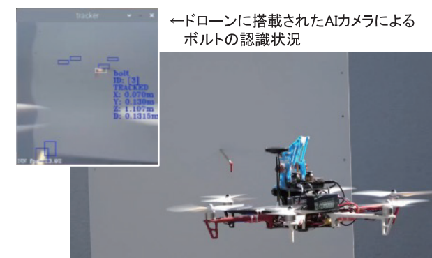
写真8 ロボットハンド搭載AIドローンにより自律して空中でボルトを掴む状況の例
