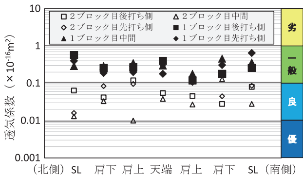
図8 覆工コンクリートの表層品質
