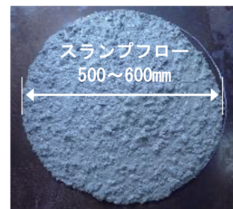
写真1 覆工用高流動コンクリート
