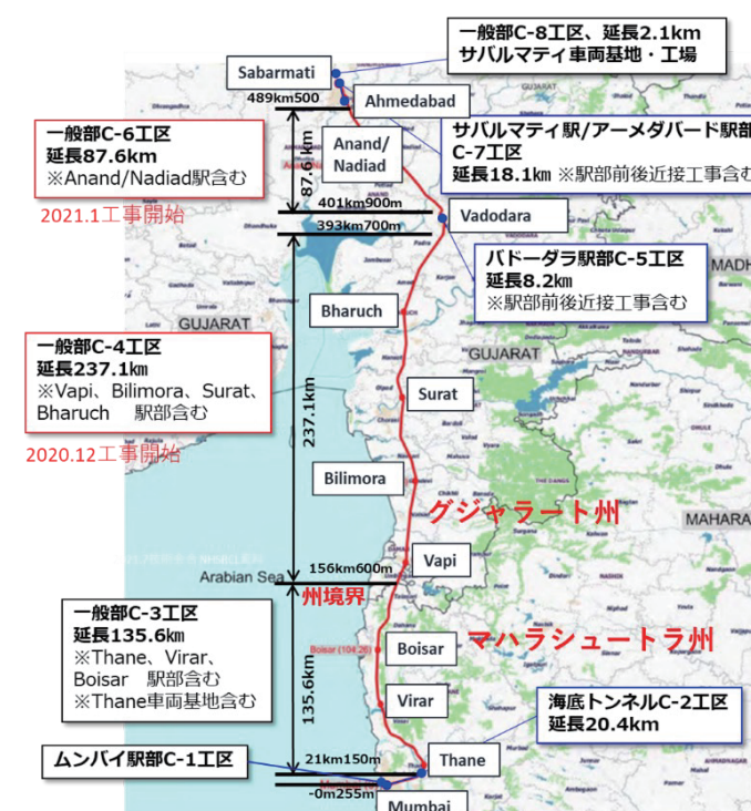
図2 駅配置と土木工事の工区割り
