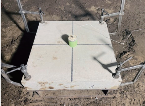
写真 1 試験体パネルとC-4爆薬の設置状況
