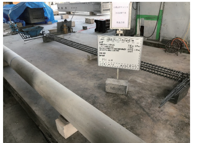
写真8 高強度ECMプレキャスト柱作製状況
