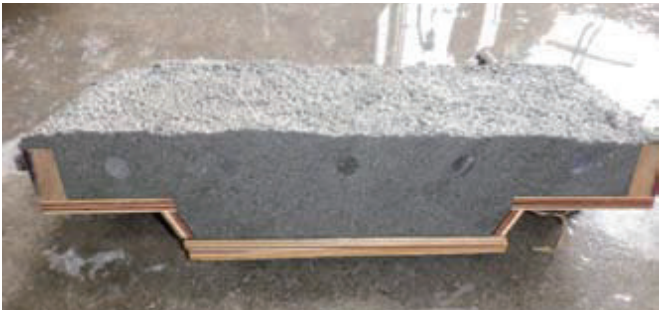
写真4 鉄筋背面への充填状況
