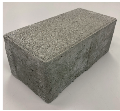
写真1 車道統一型ILブロックの形状 1)
