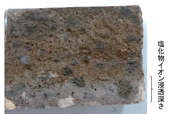
写真2 Cl - の浸透経路(N100の例)
