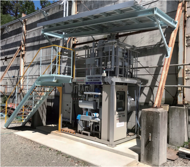
写真1 藤原工場に設置した小規模テストプラント 〔日量20kg-CO 2 回収〕
