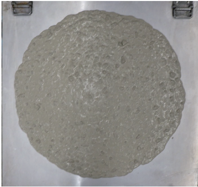
写真2 スランプフローの状況
