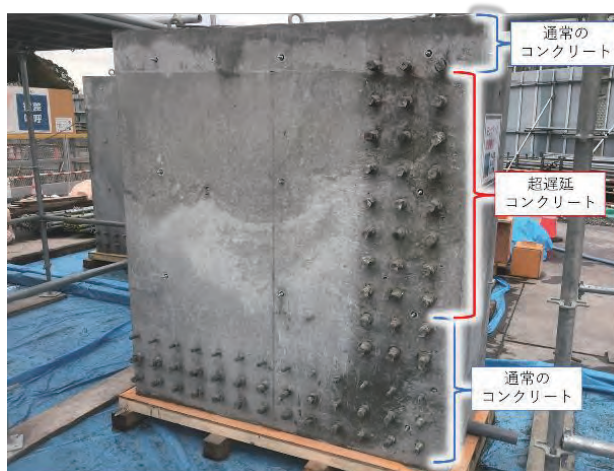
写真1 作製した大型試験体
