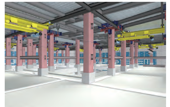
図10 全平面を鉄骨フレームで覆った例
