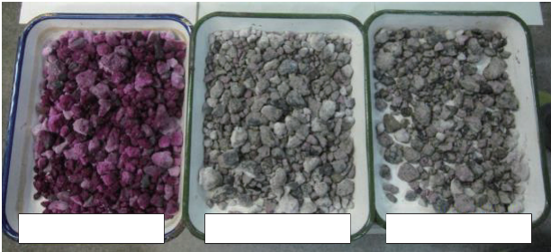
写真3 フェノールフタレイン溶液噴霧状況
