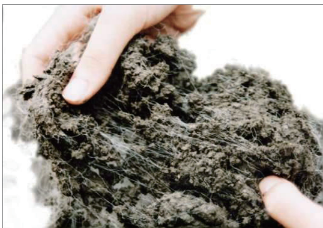
写真1 短繊維混合補強土の外観
