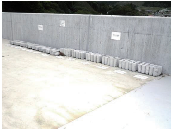
写真9 暴露試験体の設置状況
