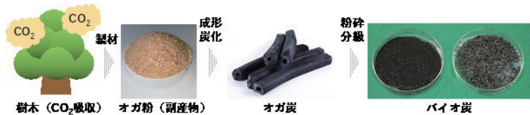
図3 使用バイオ炭の製造フロー
