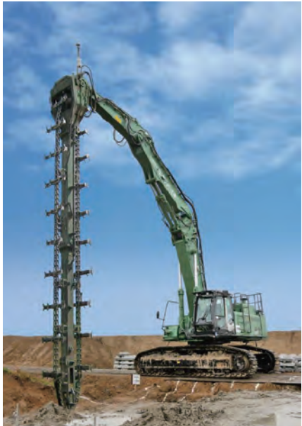
写真2 改良深度13m対応改良機PBT-1100
