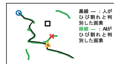
図2 AIによるひび割れ検出におけるTP/FP/FN/TNの概念図
