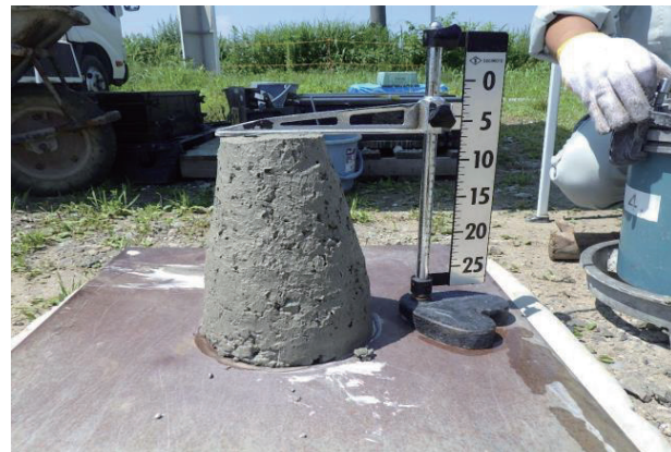
写真3 スランプ試験
