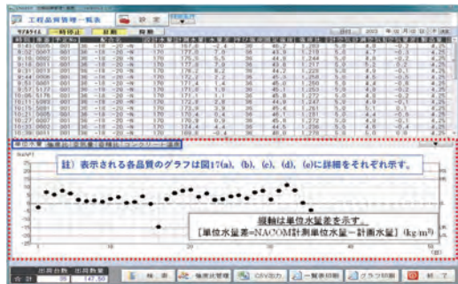
図 16 2023年2月2日製造生コンの品質管理システムによる自動管理
