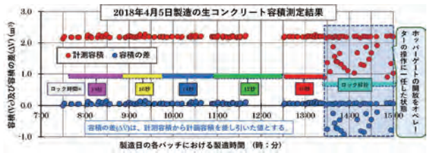
図9 排出ゲートロック時間と計測容積の関係
