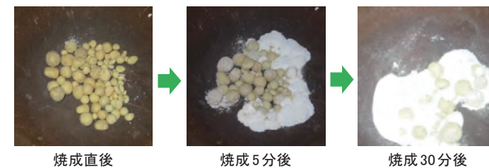
図3 自発的に粉化する現象(ダスティング)
