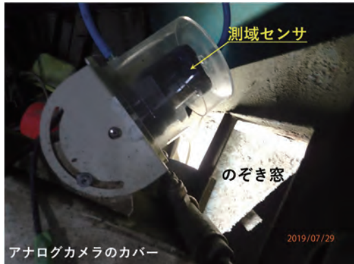
写真5 のぞき窓に設置した測域センサ
