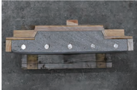
写真5 鉄筋裏背面への充填性
