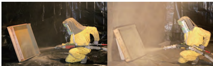
写真3 吹付け状況 [左：専用特殊ノズル 右：従来ノズル]
