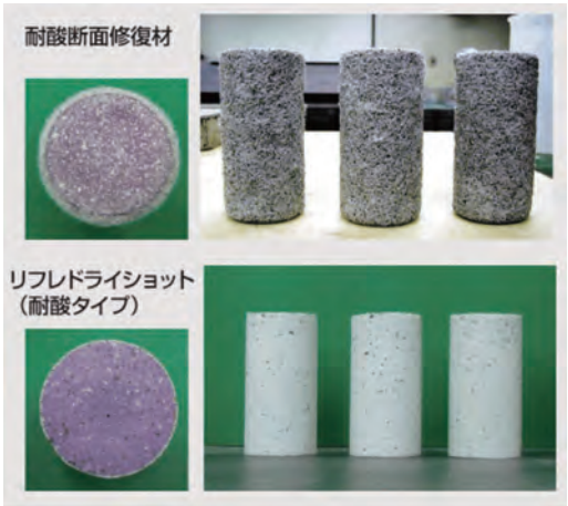
写真6 耐酸タイプ 耐硫酸性試験(材齢28日)
