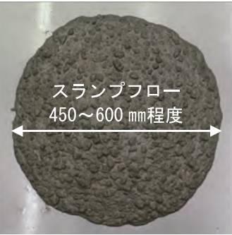
写真1 GP-SCCのスランプフロー
