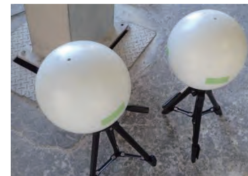
写真2 リファレンスボール
