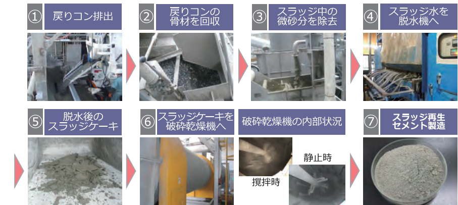
図1 再生セメントの製造工程
