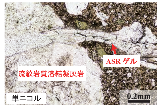
写真7 電柱外側のASR 4)
