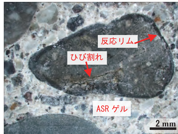
写真3 ASRによる反応リム、ASRゲルの滲出およびひび割れ
