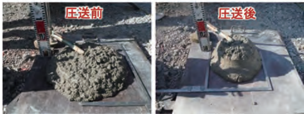
写真2 圧送前後のスランプ試験(1回目)
