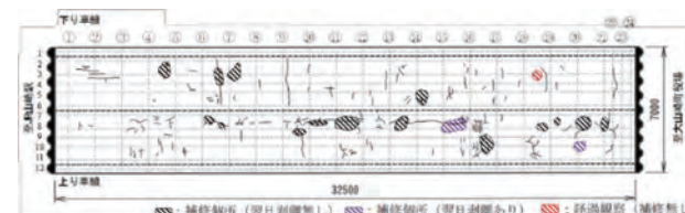
図12 供用3年補修後(2019年9月)
