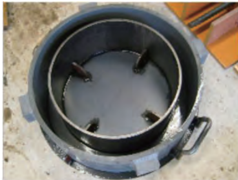
写真2 リング試験体用型枠 3)
