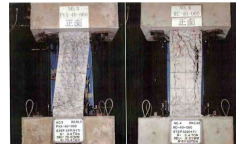
写真3 SHCCを用いた柱の加力実験例 21)
