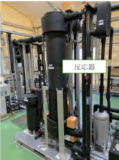
写真2 CO 2 分離回収装置の外観
