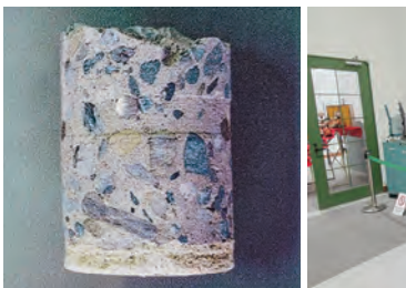
▲上屋の改修工事の際には、コンクリートの強度や中性化、鉄筋の腐食・位置等の検査が実施された。
