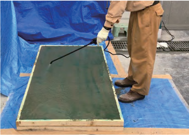
写真3 アルギン酸ナトリウム水溶液の散布状況
