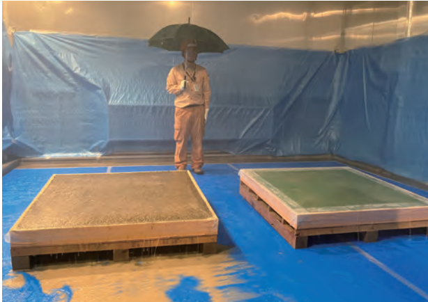
写真8 多目的人工気象再現室での風雨実験状況
