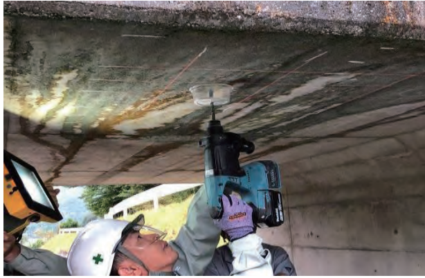
写真4 ドリル粉末採取状況(塩化物イオン量測定用)
