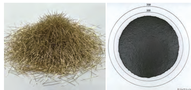
写真1 鋼繊維およびフロー試験の状況
