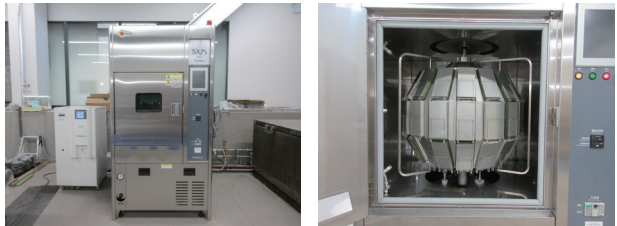
写真1 耐候性試験機キセノンウェザーメーター
