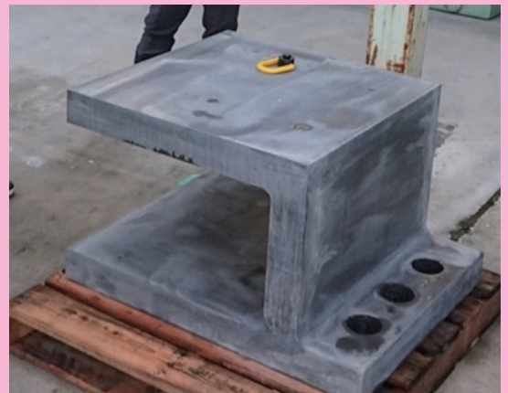
超高強度繊維補強コンクリートを用いた盛土式ホーム柵の基礎
