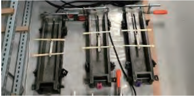
写真 1 埋め込み型ひずみ計と供試体型枠
