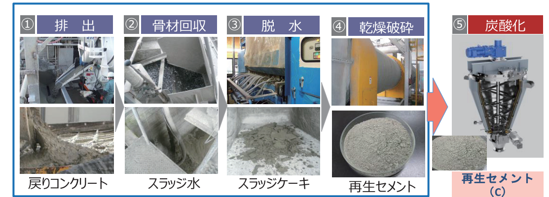
図1 再生セメントと再生セメント(C)の製造工程およびCO 2 排出原単位
