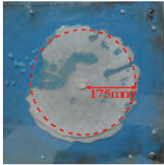
図1 φ30mmの孔から流動性モルタル充填した範囲 (1) 隙間 5mm (2) 隙間 10mm
