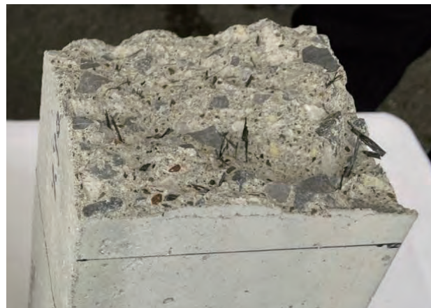
写真8 曲げ靱性試験後のコンクリート断面 (黒く細長い再生炭素繊維)
