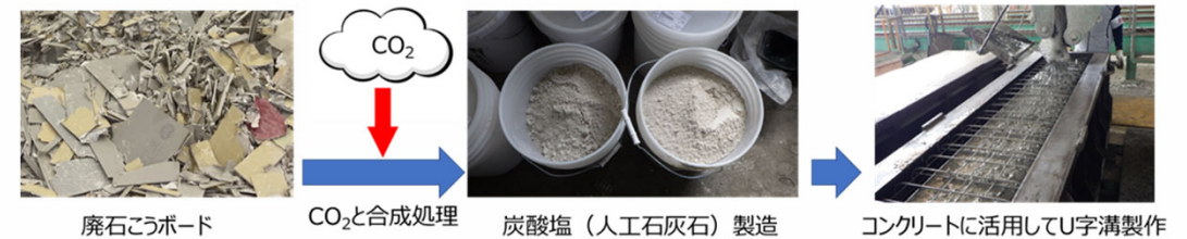
<人工石灰石およびU字溝の製造過程>
