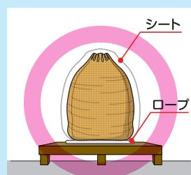
図のように保管し、シートは風に飛ばされないようロープ等で固定してください。
