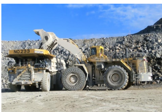
写真7 超大型ホイールローダー・ダンプトラックによる採掘状況
