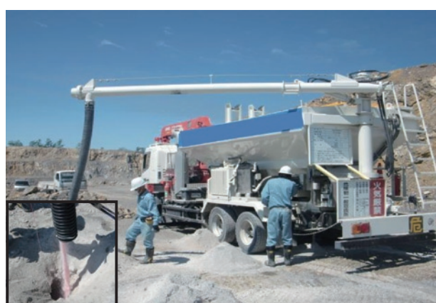
写真9 ANFOサイトミキシング(左下は装薬状況)
