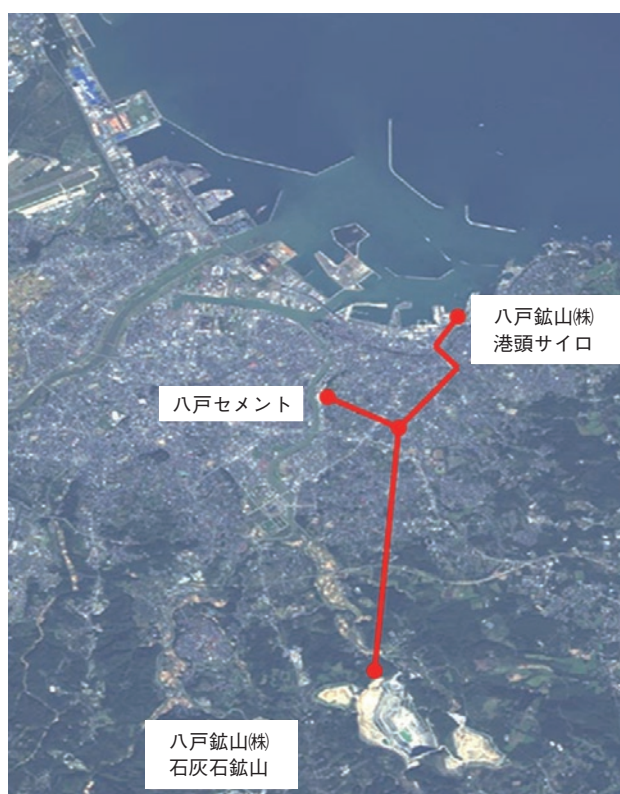
写真3 地下ベルトコンベアのルート
