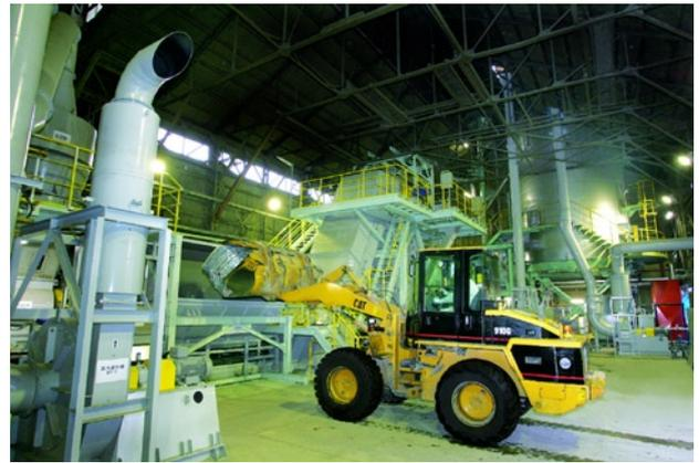
写真8 廃プラスチック投入の様子
