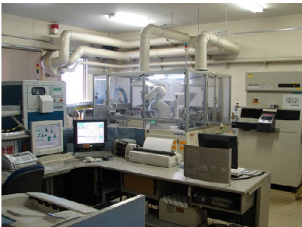
写真5 工程管理用自動分析システム
