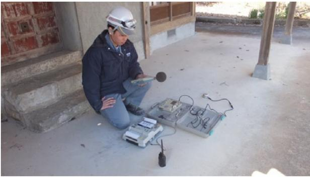
写真4 発破騒音・振動測定風景
