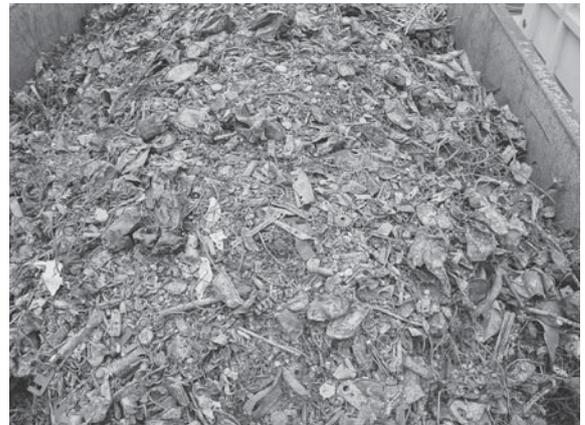
写真2 湿灰から回収された金属くず
