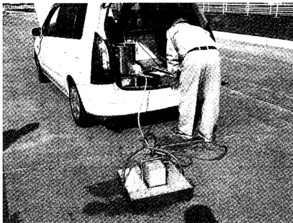
写真 2-11 DFテスターによる すべり抵抗値の測定状況
