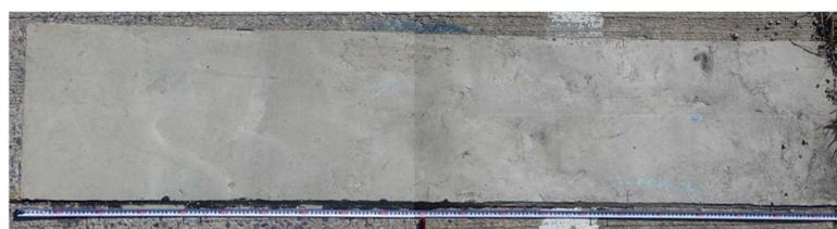
写真-5.5 目視調査結果(35万輪走行後、ゴム系接着剤使用)
