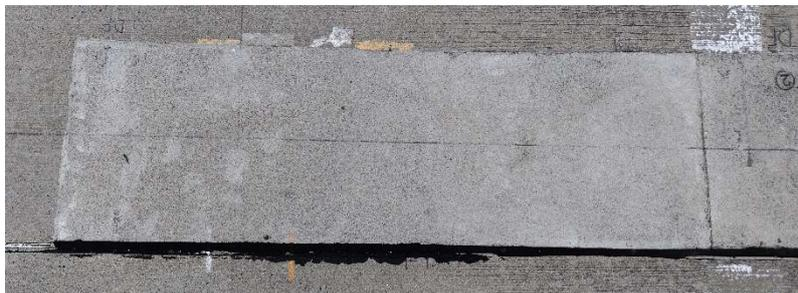
写真-5.9 目視調査結果（115 万輪走行時点）
