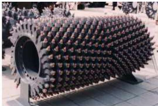
写真-4.1 コールドミリング工法に使用される切削ビットを多数付けた切削ドラム
