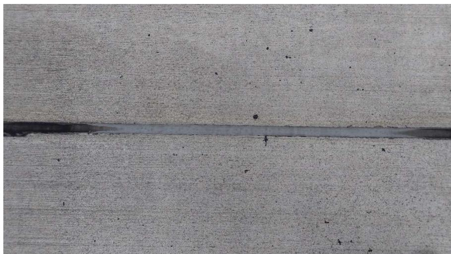
写真-5.15 トスシール 8 1 1 目視調査結果（115 万輪走行時点）
