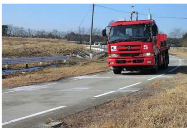
写真-5.2 促進載荷試験用荷重車
