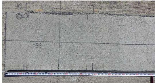
写真-5.8 目視調査結果（35 万輪走行時点）
