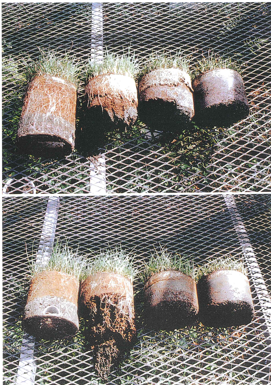
写真－5 セメント系固化材の添加量の異なる条件下におけるケンタッキー・31・フェスキューの播種から170日後の掘上げ後の状態
