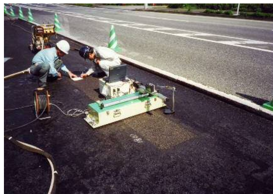
写真 4-19 テクスチャ測定状況
