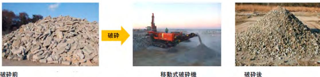
写真 3.7.1 震災コンクリートガレキの破碎状況<sup>4)</sup>
