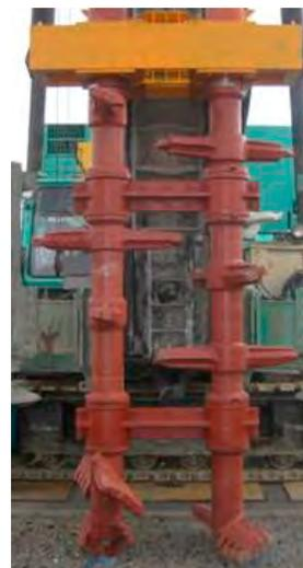
写真 4.13.3 攪拌翼の詳細
