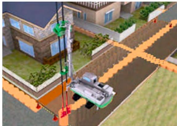
図 3.3.2 格子状地中壁工法のイメージ<sup>2) 3)</sup>
