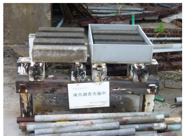
写真 2.1.15 曝露状況(材齢 22 年～30 年)
