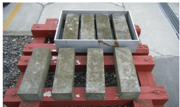
写真 2.1.9 材齢 30 年引上げ時 曝露状況
