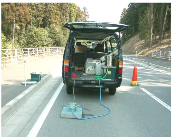
写真 2-23 回転式すべり抵抗測定器（DF テスタ）による動的摩擦係数の測定状況
