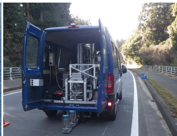
写真 2-25 FWD によるたわみの測定状況
