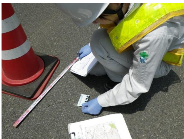
写真 2-20 ひび割れの測定測定状況
