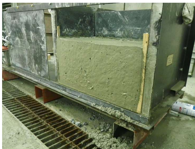
写真 2-1 エッジスランプ試験の様子
