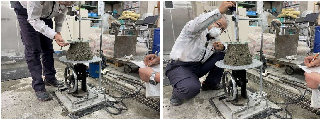
写真 2-3 テーブルフロー試験の様子
