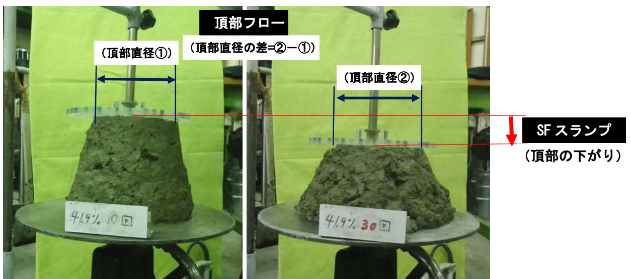
写真 2-4 テーブルフロー試験の SF スランプと頂部フロー
