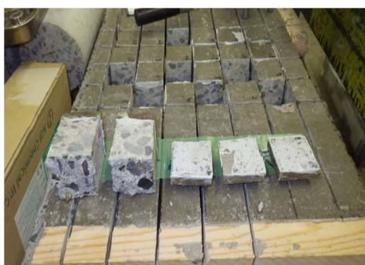
写真-25 材齢 28 日、接着剤有り
