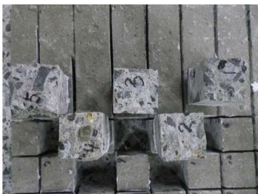
写真-23 材齢 1.5 日、接着剤有り
