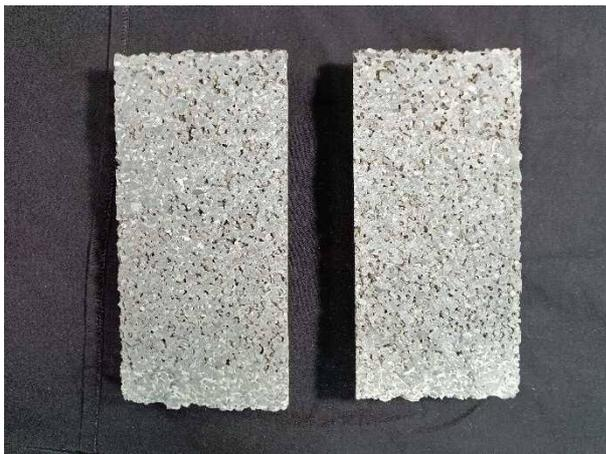
写真-3.3 aタイプの割裂後の断面
