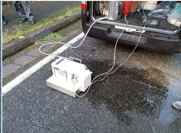
写真-2.22 回転式すべり抵抗測定器 (DF テスタ) による動的摩擦係数の測定状況
