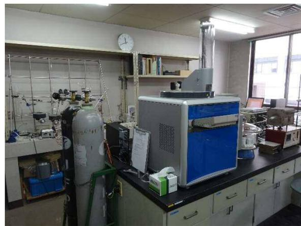
写真-2.39 測定に用いた炭素分析装置
