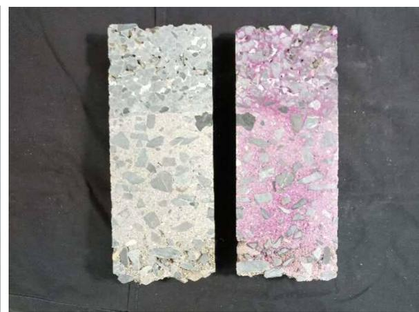
写真-3.6 bタイプの中性化試験結果(右)
