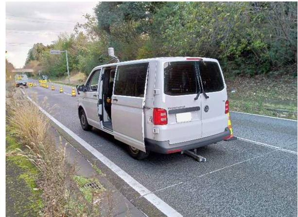
写真-2.25 FWD によるたわみの測定状況
