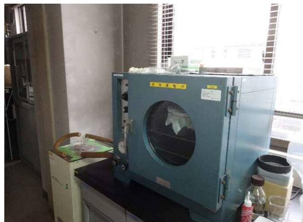
写真-2.33 真空乾燥装置による真空乾燥
