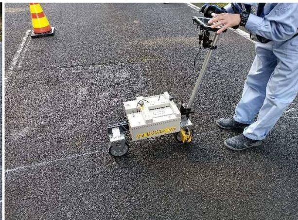
写真-2.24 わだち掘れの測定状況
