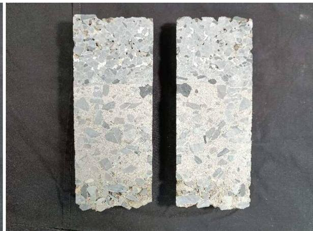
写真-3.4 bタイプの割裂後の断面
