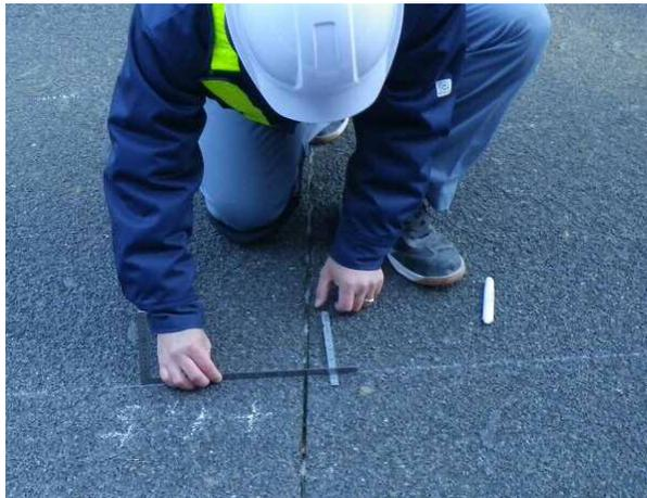
写真-2.21 目地の段差の測定状況
