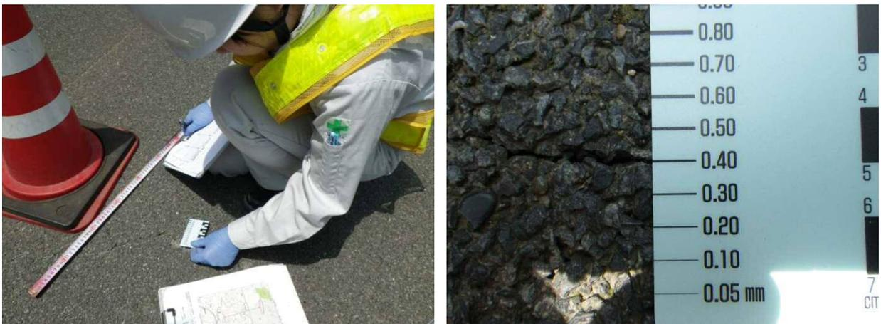
写真-2.20 ひび割れの測定状況
