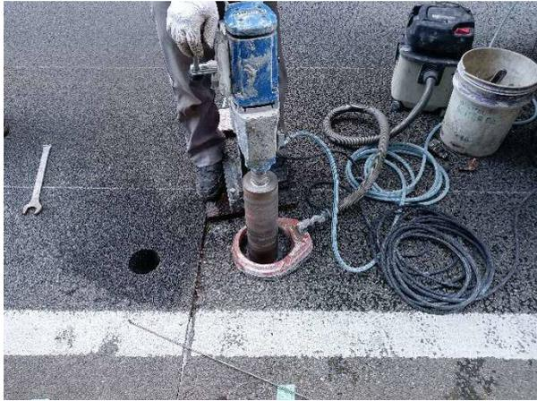
写真-2.26 コア供試体の採取状況
