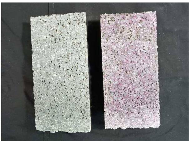
写真-3.5 aタイプの中性化試験結果(右)
