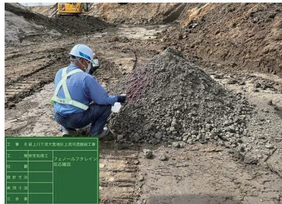
写真 5 アルカリ性反応試験
