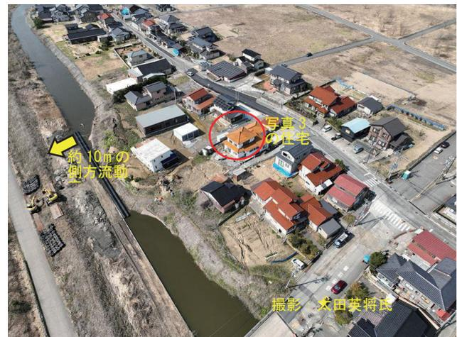
写真4 内灘町の住宅の側方流動の状況
