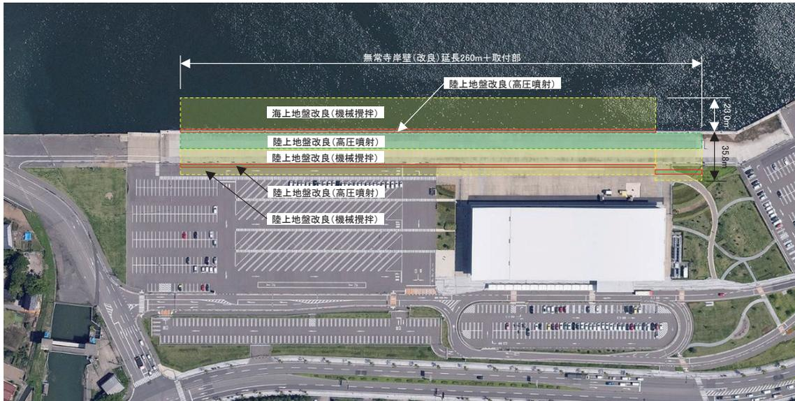
写真5 無量寺ふ頭の耐震強化岸壁の整備状況（写真：石川県提供）
