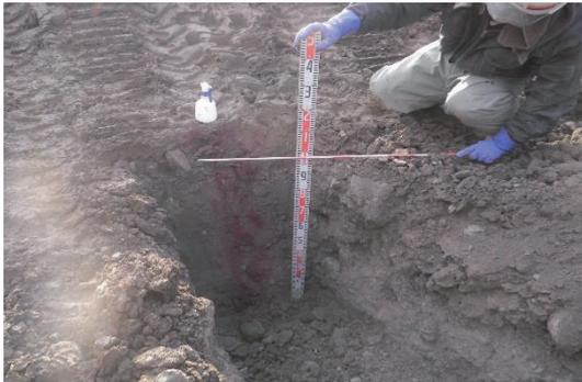
写真7 混合状態の確認
