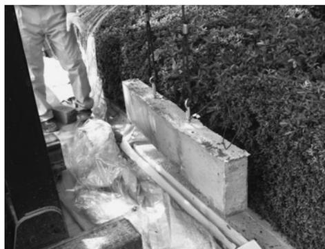
打設後24時間でアルミ製型枠から供試体を抜き取り。曲げ強度4.5N/mm<sup>2</sup>の目標強度をクリア
