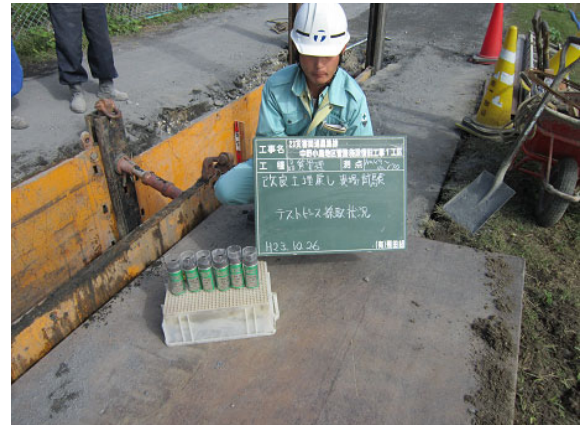
写真 5.2.9 一軸圧縮試験用供試体
