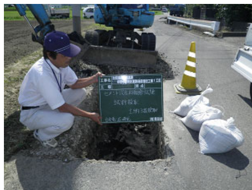
写真 5.2.3 配合試験用試料土の採取状況
